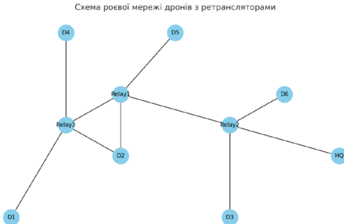
Рис. 1. Схема роєвої мережі дронів з ретрансляторами
