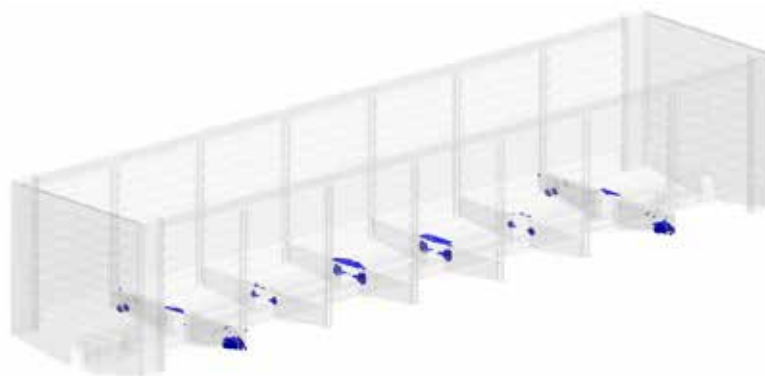
Рис. 4. Найбільш навантажені зони кузова напіввагона
