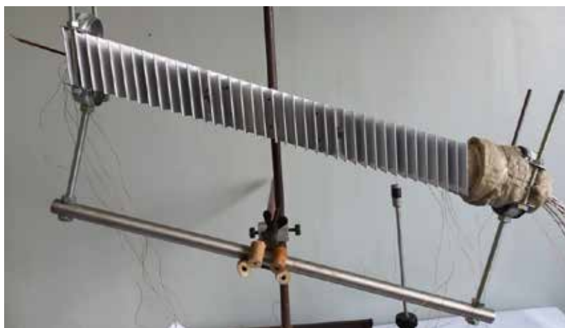
Рис. 4. Розміщення гравітаційної теплової труби на експериментальній установці
